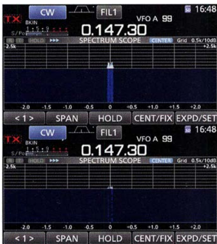
Bild 5: Maximum (oben) und Minimum (unten) beim Empfang von DWD DDH47
