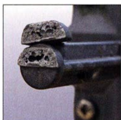
Bild 3: An der Bruchstelle des aus Gusseisen bestehenden alten Halters sind mehrere Hohlräume (Lunker) sichtbar.
