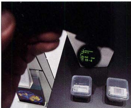
OLED-Datenbrille des Fraunhofer FEP für Augmented reality
