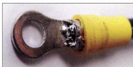
Bild 9: Doppelt „genäht“, also gequetscht und gelötet, hält besser – besonders dann, wenn man nur behelfsmäßig crimpsen kann.
