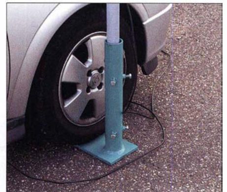
Bild 8: Der Antennenmast wird mit dem Pkw beschwert.
