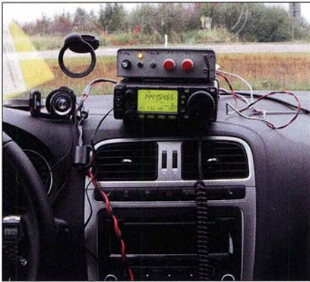
Bild 3: Icom IC-706 MKIIG mit dem Sprachfilter Lingua auf dem Armaturenbrett – für den Betrieb im Stand
