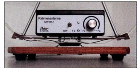
Bild 3: Das Gehäuse mit dem Drehkondensator trägt den Rahmen und ist drehbar auf der Grundplatte montiert.
