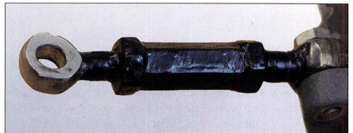
Bild 1: Gebrochene Halterung der Antenne
