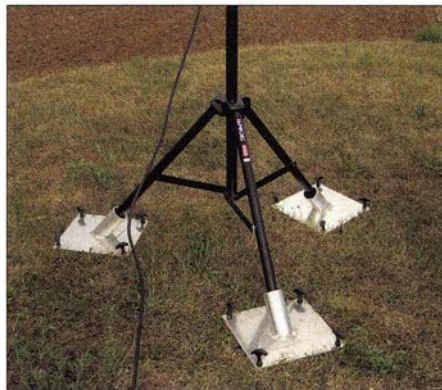
Bild 7: Ein einfaches Stativ erfordert zumindest eine Befestigung am Boden.
