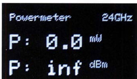
Bild 2: Auf dem OLED-Display wird die Leistung in Milliwatt bzw. Watt sowie Dezibel pro Milliwatt angezeigt.
