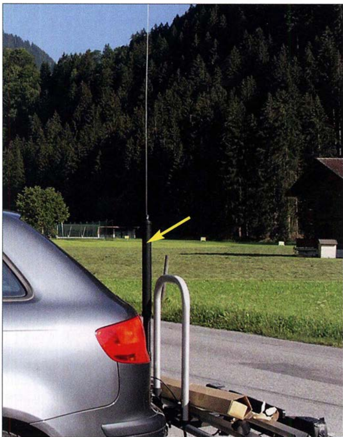
Bild 1: Als Beispiel für eine KW-Mobilantenne dient hier eine kommerzielle Ausführung vom Typ Yaesu ATAS-120A, montiert am Fahrradträger eines Kfz; die motorbetriebene Abstimmspule (Pfeil) befindet sich im gekapselten Teil am unteren Ende der Antenne.
