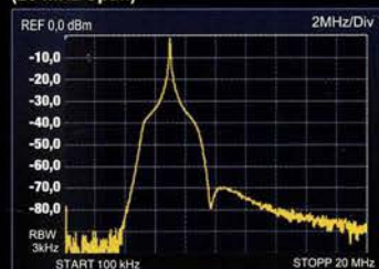
Resultierende Durchlasskurve von VC-Tune und Bandpass bei 7 MHz (20 MHz Span)
