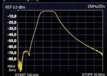
Durchlasskurve des Bandpasses bei 7 MHz (20 MHz Span)
