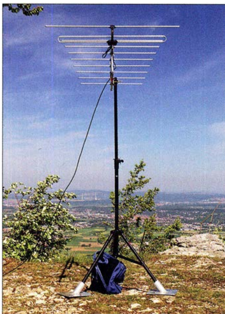
Bild 9: Bereits ein einfaches Stativ, das eigentlich für Lautsprecherboxen gedacht ist, eignet sich zum Aufbau einer UKW-Yagi.
